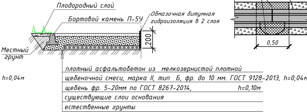
КОНСТРУКЦИЯ ПОКРЫТИЯ ОТМОСТОК Туп IIIb
