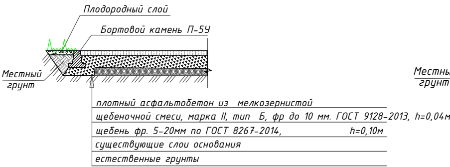
КОНСТРУКЦИЯ ПОКРЫТИЯ ТРОТУАРОВ Туп III
